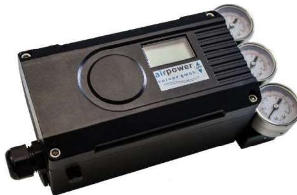
Der AVP-350 SMART ist ein IP-Stellungsregler in Zwei-Leiter-Technik mit Eingangssignal 4 ...20 mA der airpower europe GmbH. Dieser Stellungsregler dient der Steuerung eines pneumatischen Antriebes von Armaturen. Zum Einsatz kommen Stellungsregler in automatischen Steuerungssystemen in der chemischen Industrie, in der Energiewirtschaft, der metallverarbeitenden Industrie, Papier- und Zellstoffindustrie und vielen anderen Bereichen.
